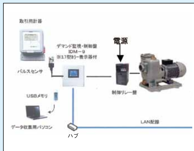
デマント監視を兼ねた給水装置
