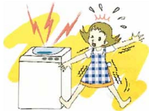
機器が接地されていれば、漏電電流は大地を流れてキュービクルの変圧器に戻ります。このとき、キュービクルに付けられている漏電警報器が作動し警報を発します。
