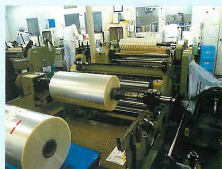
スリッター主要設備 (アルミ箔スリッター関係設備 5台、フィルムスリッター関係設備 4台)
