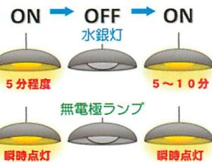
水銀灯は初回点灯に5分、一度消すと次の再点灯まで5~10分ほど待たなければなりませんが、無電極ランプは瞬時点灯なので、瞬間停電などの場合でもすぐに点灯するから非常用照明としても安心です。また、こまめな電源ON/OFFができるので節電にも効果大です。
