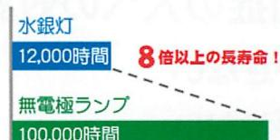
無電極ランプの消費電力は、同じ明るさの水銀灯の約1/3程度、400Wの水銀灯を150Wの無電極ランプで代替できます。電気代を大幅にカットして省エネ、節電に役立ちます。
