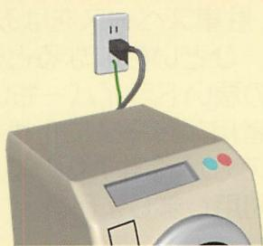
洗濯機や衣類乾燥機、冷蔵庫、エアコン、電子レンジなどにはアース線が付属されています。感電防止のため、アースを接続して使いましょう。
