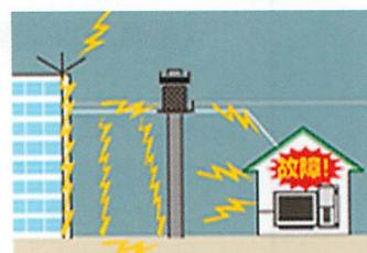
**直撃雷**…接続された電線に直接落雷して侵入する雷サージです。
