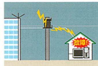
**雷サージによる被害内容** 電気ストーブやドライヤなど、電気→熱、電気→動力のような単純に変換をかけている機器では雷サージによる被害はほぼ起りません。これは半導体集積回路が過電圧、過電流に大変弱い事に端を発しています。また、雷サージで機器破損が起こる事例のほとんどは、通信系（電話線）に集中しています。
