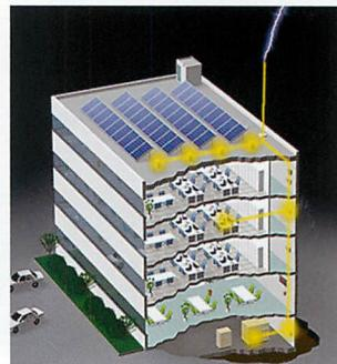
**雷サージとは** 落雷時、電線などの高所にあるものに瞬間に発生する有害な過電圧や過電流のことです。電話線、電源線、アンテナ、大気中を通って家の中に進入し、このサージ電圧によってパソコン・ルーターなどの電子機器は、絶縁破壊や誤作動・劣化などの影響を受けます。市販品の雷ガード機器使用で、内蔵された吸収素子（バリスタ）が雷サージを吸収することで、接続するパソコンなど故障を防ぐことが出来、雷サージ対策として最適です。
