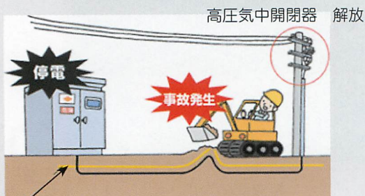
埋没表示シート 事故時の状況
